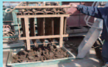
ケーキ剥離完了
